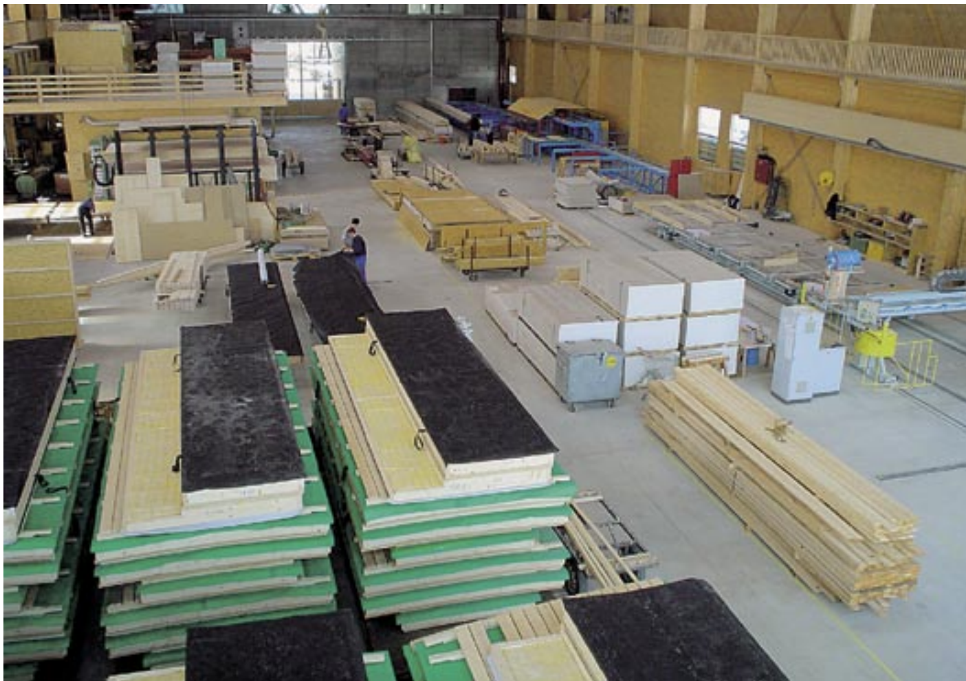
Obr. 4.9 Technologická linka na výrobu panelů [7]
