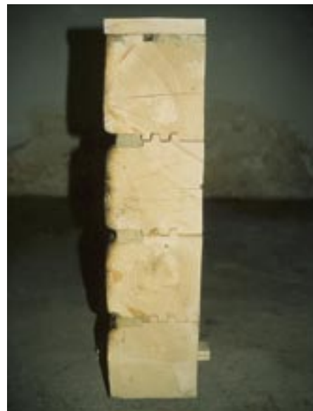
Zkušební vzorek po 90 min. přímého účinku plamene
