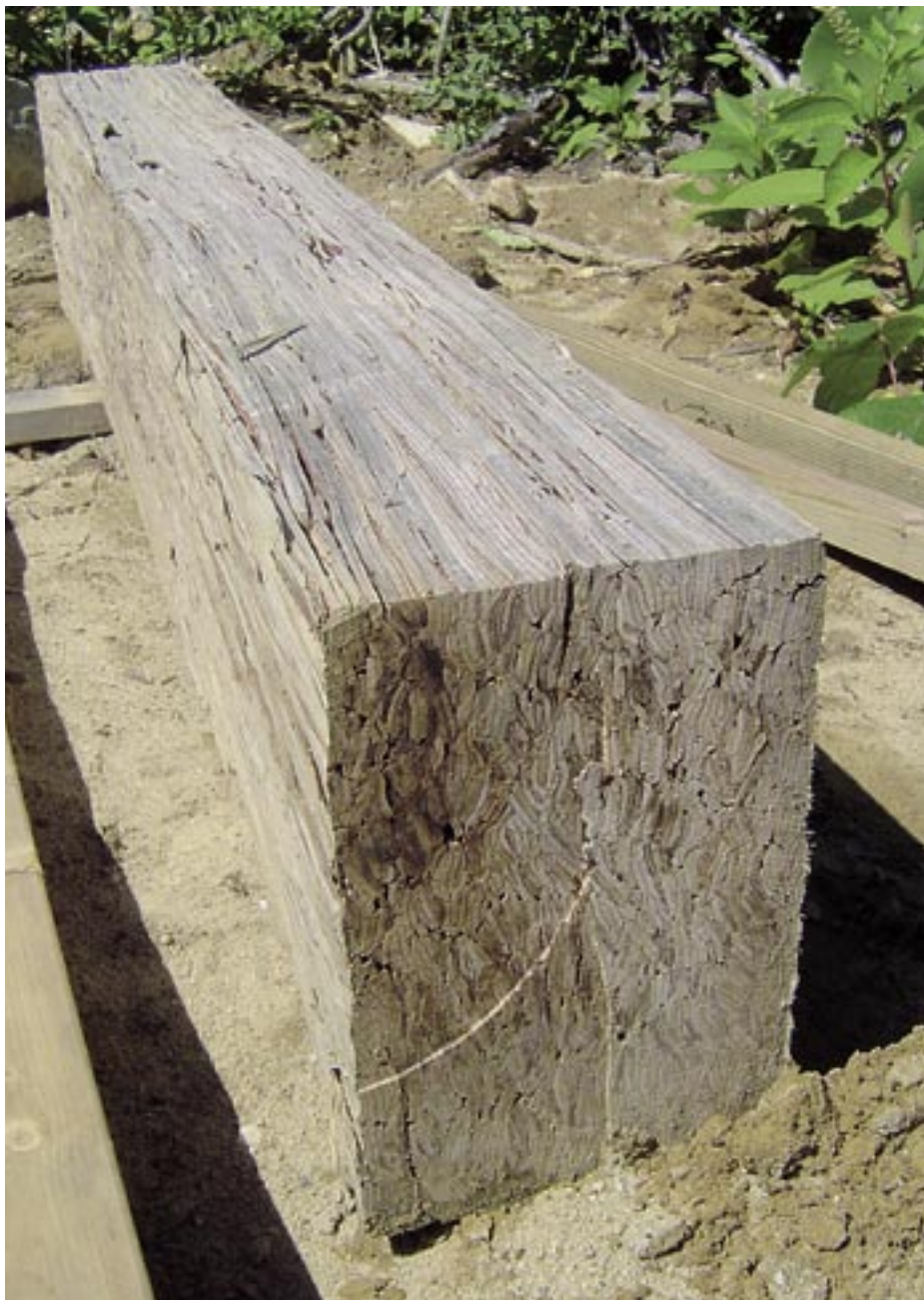
Obr. 3.10 Nosník z lisovaných dýhových pásků [5]
