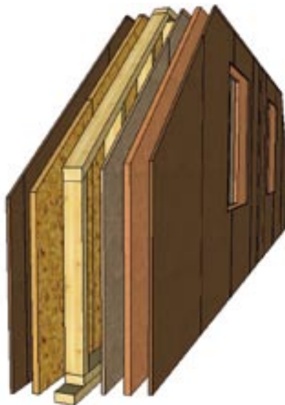
Obr. 4.3 Skladba celostěnového panelu [34]
