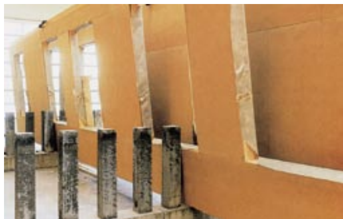
Obr. 4.11 Skladování hotových panelů [23]
