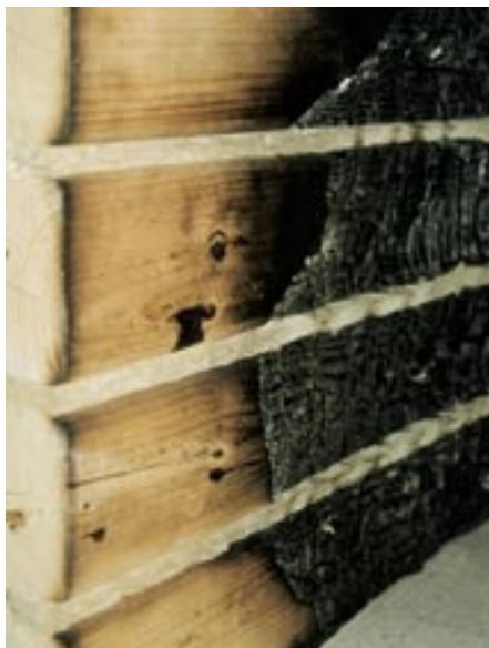
Zuhelnatělá vrstva eliminuje další průnik plamene
