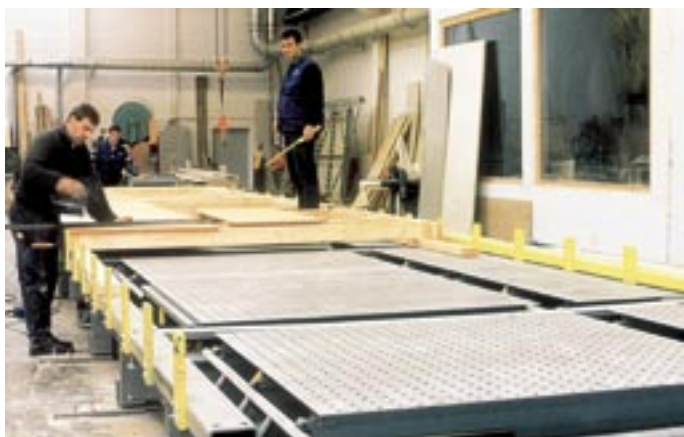
Obr. 4.10 Vodorovná plošina – pódium pro opláštování panelů [23]
